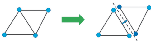
图 9 接触面工作原理 Fig. 9 Working principle of contact surface
