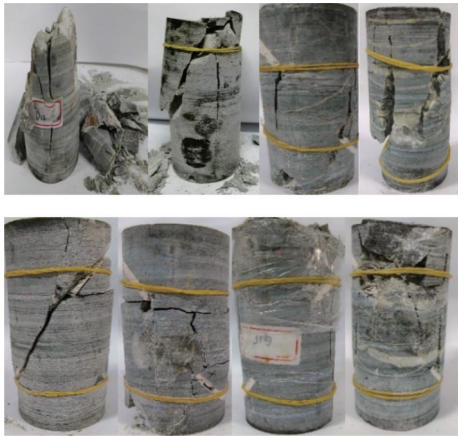
图 9 三轴加卸荷试样典型破坏特征图
