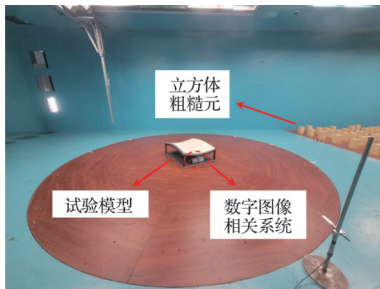
图 5 试验段中膜结构模型及测量设备的布置图
