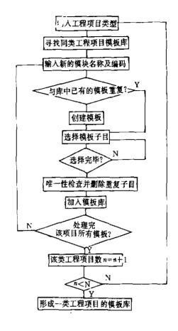
图 1 预算模块建立算法流程图
