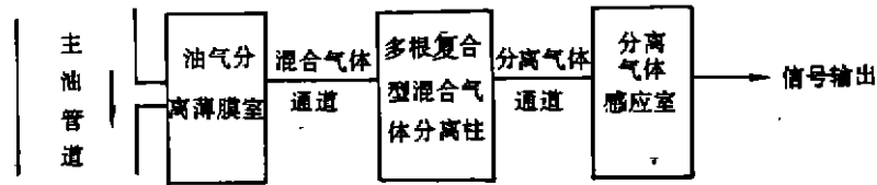
图 7 F_{46} -GDX- SO_2 原理性框图
