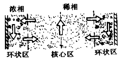
图 3 “核心-环”流动示意图
