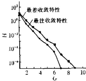
图 2 CGALF 法求取轻载情况下正常解的收敛特性曲线
