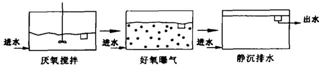
图 1 连续进水间歇出水的 SBR 除磷工艺示意图
