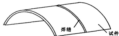
图1 弧形铍焊件
