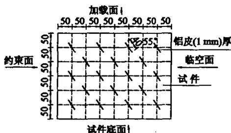
图1 碎裂结构岩体模型试件图(单位:mm)
