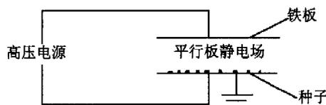
图1 高压静电场种子处理装置示意图
