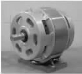
图 4 磁流变传动装置样机
