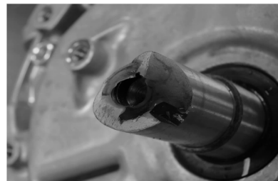
图 8 400 h 耐久试验使用球墨铸铁材料的曲轴断裂图
