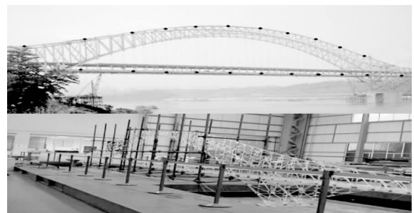
图 2 朝天门大桥、模型及测点布置
