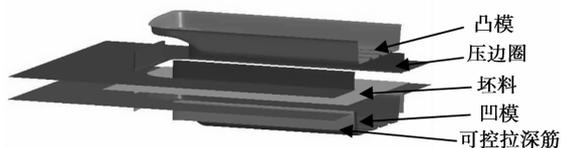
图 5 引擎盖边板有限元模型
