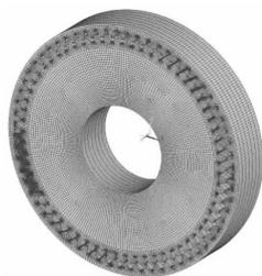
图 4 内啮合齿轮副三维有限元接触模型
