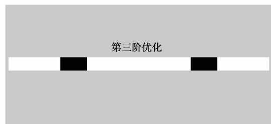
图 5 简支梁三阶模态阻尼比拓扑优化
