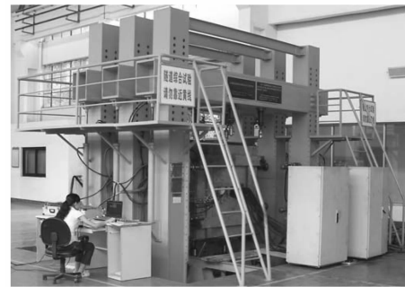
图 2 公路隧道及围岩综合实验系统
