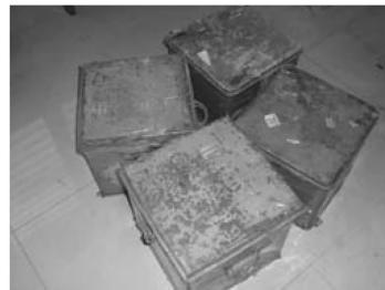
图 1 Q_2 原状黄土土样搬运
