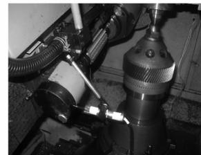
(c) 位移传感器a工作过程的实测照片
