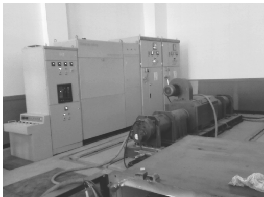
图7 采煤机工况参数模拟实验台
