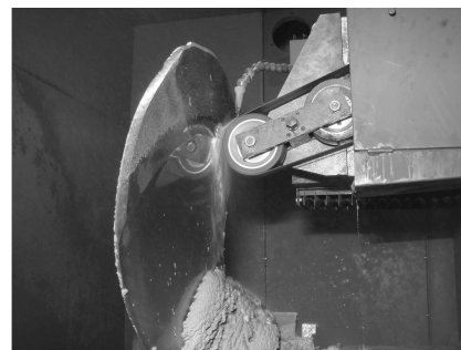
图5 四轴联动砂带磨削桨叶试验
