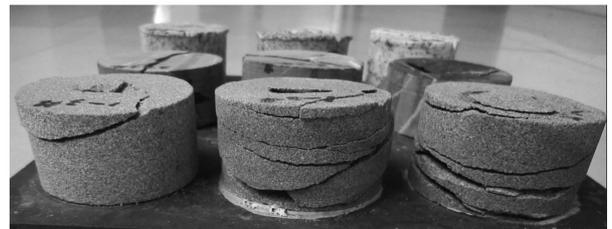
图 12 砂岩试样的横向裂纹面
