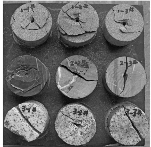
图 11 不同岩石在脉冲射流下的破坏
