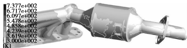
图6 歧管式催化转化器外流场内壁面温度分布
