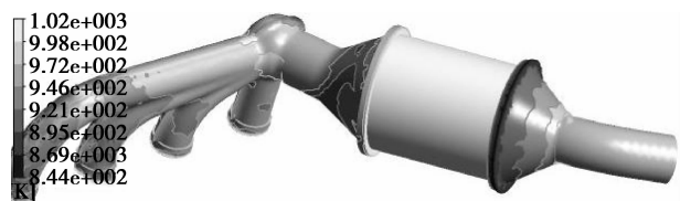
图5 歧管式催化转化器内流场外壁面温度分布
