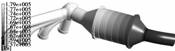
图 9 歧管式催化转化器内流场外壁面的压力分布
