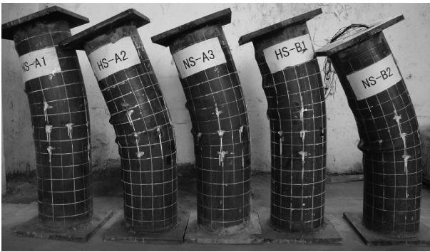
图 4 试件的破坏状态
