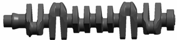
图7 曲轴三维模型图
