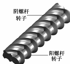
图 2 螺杆转子实体模型
