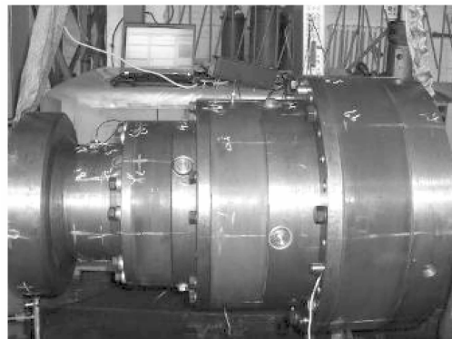
图3 自由模态测试现场
