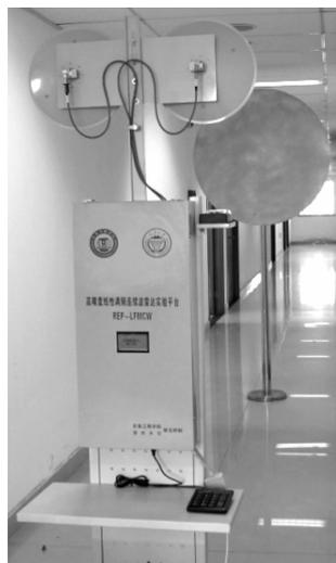
图 5 LFMCW 雷达实验平台实物图
