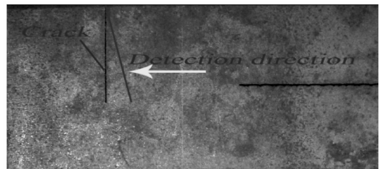
图 13 带有裂纹的被测铁块
