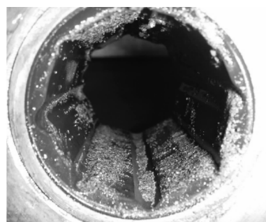
图13 直槽水润滑轴承泥沙分布 (含沙量 3.38%)
