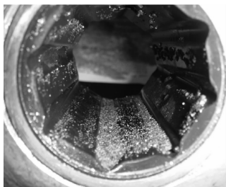
图9 直槽水润滑轴承泥沙分布 (含沙量 0.27%)
