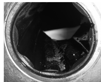
图8 螺旋槽水润滑轴承泥沙分布 (含沙量 0.27%)
