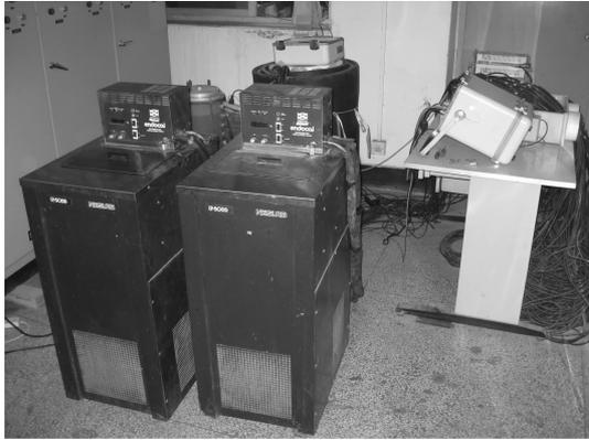
图 3 冻结过程土体水分迁移测试系统实体图
