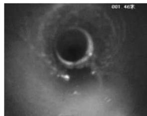
(a) 爆破前距孔口 1.46 m 处孔内观测
