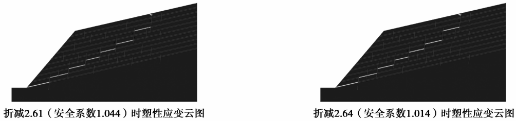
图 4 双向顺层边坡破坏特征示意图
