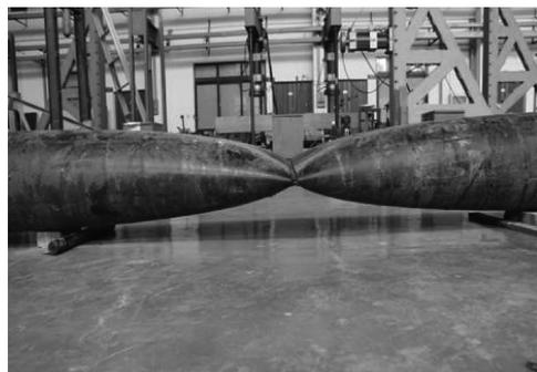
图 7 钢管压扁后变形图
