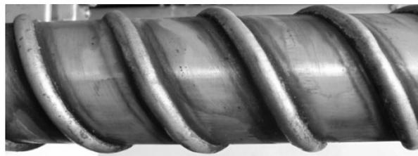
图 9 熔涂螺旋钻杆
