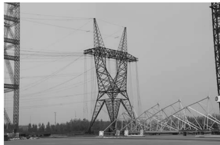
图 1 JBB551 转角塔在试验中
