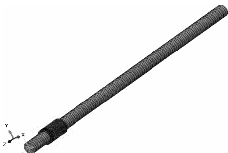
图1 水润滑橡胶合金轴承系统有限元模型 Fig.1 Finite element model of bearing system
