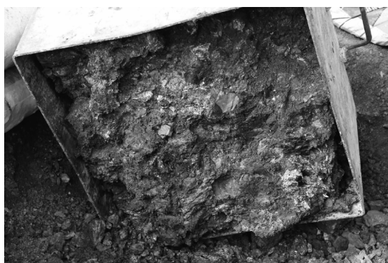
图 5 现场大型剪切试验试样剪切面
