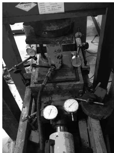
图6 室内直剪试验
