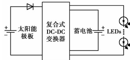
图 2 新型太阳能路灯控制器
