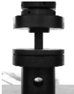
图 4 岩石试件安放图 Fig.4 Rock sample installation
