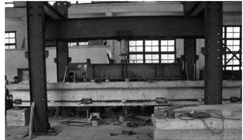
图 5 梁试验加载图
