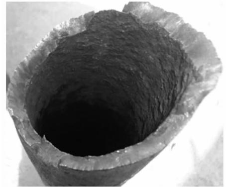
图 1 钻杆管体断裂
