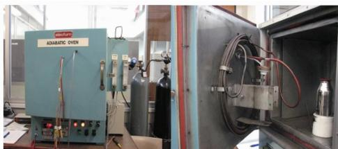
图 1 绝热氧化实验装置实物示意图
