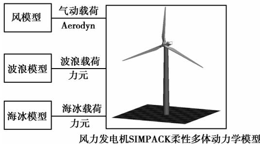
图 3 风力发电机组仿真过程
