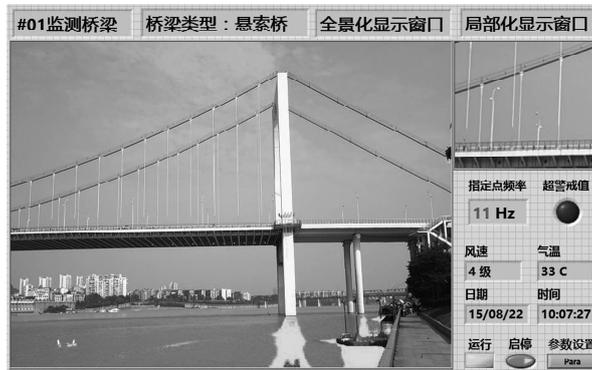
图 4 基于 LabView 开发的桥梁振动状态监测软件主界面
