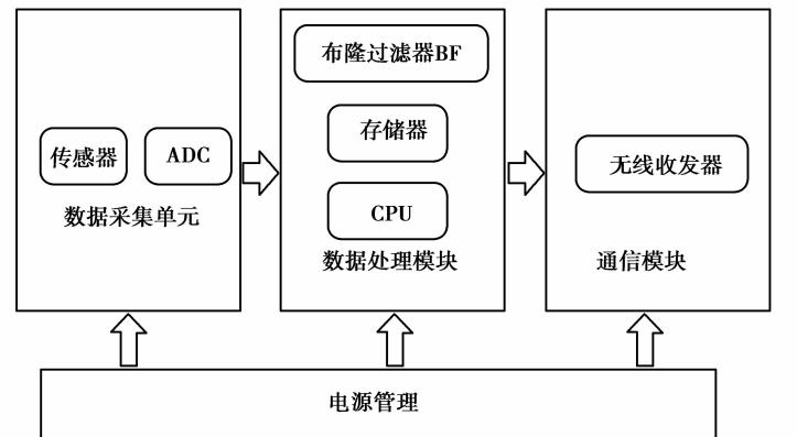
图 1 带布隆过滤器 BF 的传感器节点
