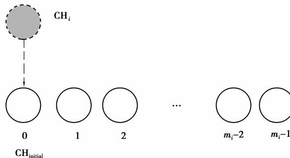
图 2 传感器节点编址示意图
