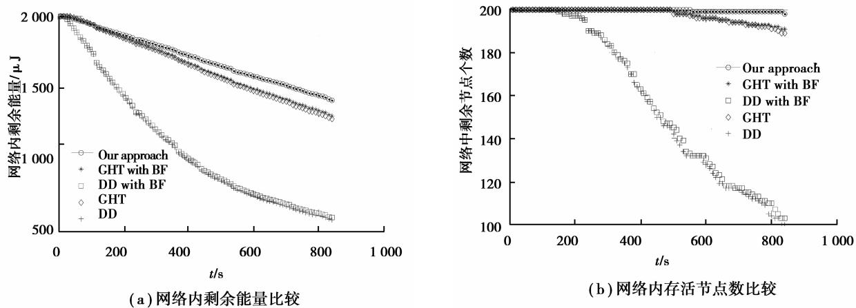
图7 GHT、DD 和我们所提算法在使用布隆过滤器后在网络寿命方面的比较
