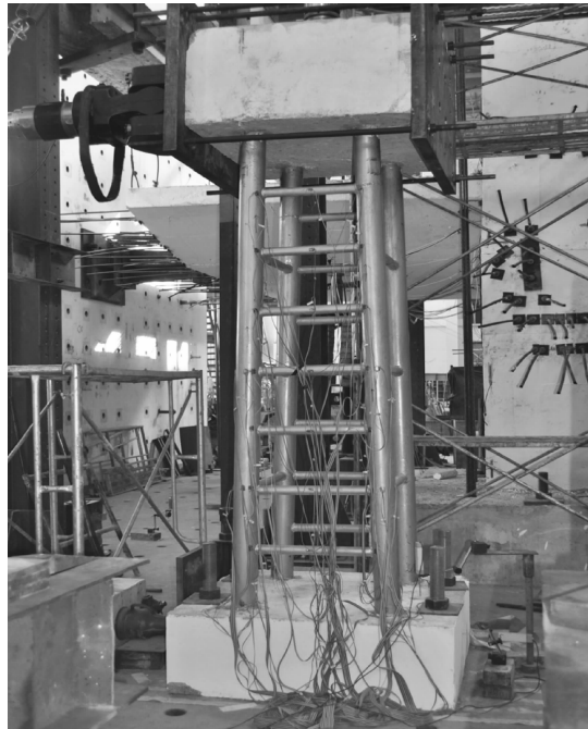
图 1 平级管式钢管混凝土格构柱拟静力试验 (BP-1)
