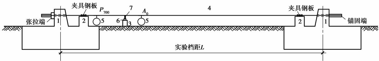
注:1.张拉系统,2.终端夹具,3.振动系统,4.输电导线,5.位移传感器,6.加速度传感器,7.力传感器
