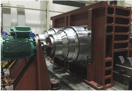
图 13 升降齿轮箱试验台架
